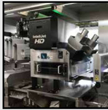
HD ServoWAS auf einer Pharma-Blisterverpackungsmaschine
