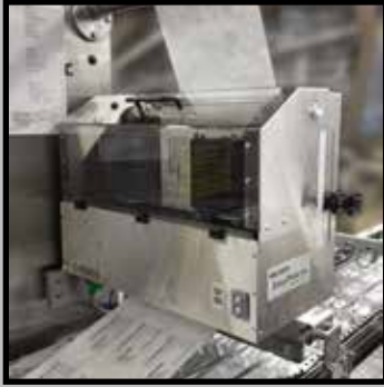
Montiert auf einer HFFS-Verpackungslinie für medizinische Geräte
